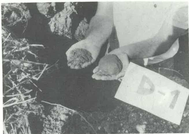
Fig. 17 - Material encontrado no interior do tubo poroso (mão esquerda) no dreno com granulometria tipo DNER
