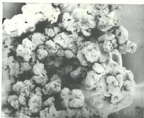
Fotografia 1 - Estrutura característica do solo poroso do Distrito Federal.
