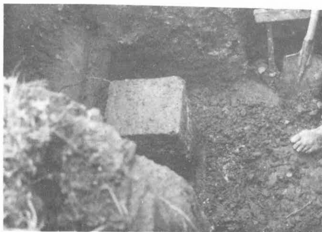
Fig. 16 - Amostra indeformada da parede do solo imediatamente em contato com o dreno
