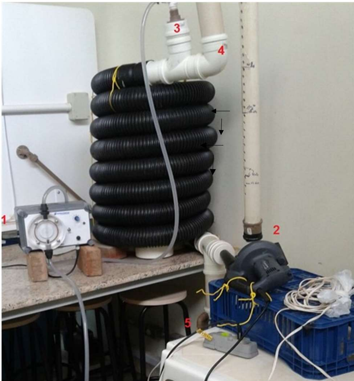
Figura 1 - Instalações experimentais: (1) bomba dosadora; (2) soprador de ar (3) entrada da água residuária no canal corrugado; (4) saída do ar + NH 3 ; (5) saída da água residuária tratada
