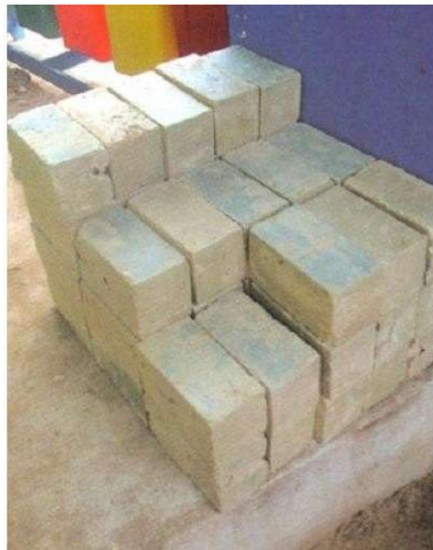
Imagem 3 - Blocos de solo cimento reciclados Fonte: Morand (2016, p. 78)
