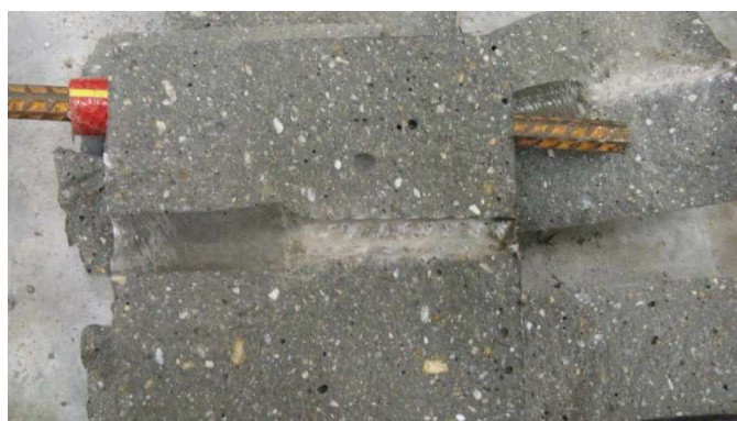
Figura 12 - Ruptura do corpo de prova de concreto pós reativo Fonte: Autora, 2016.
