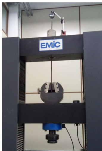
Figura 6 - Configuração do ensaio de arrancamento direto Fonte: Autora, 2016.
