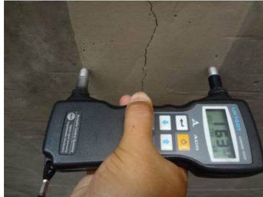
Figuras 1 y 2 – Medición del ancho de una fisura y medición de la profundidad de una fisura con equipo de ultrasonido.
