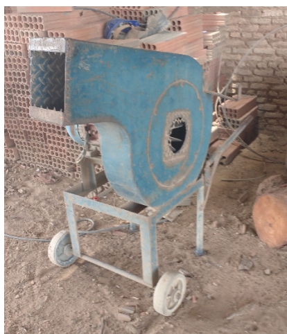
Figura 02 – Bomba para lançar as cinzas ao ar utilizadas em São Gonçalo do Amarante/RN. (foto do autor).
