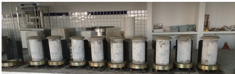
Figura 04 – Capeamento dos corpos de prova. (foto do autor).
