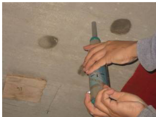
Figuras 6 y 7 – Ensayo de esclerometría y ultrasonido.
