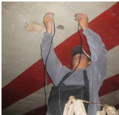
Figuras 6 y 7 – Ensayo de esclerometría y ultrasonido.
