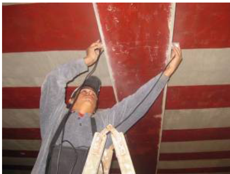
Figuras 11 y 12 –Vista de la losa evaluada y ensayo de ultrasonido.
