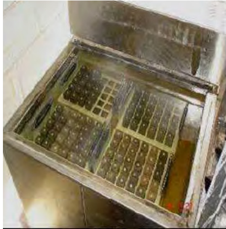
Figura 3 - Banho térmico NaOH 1N controlado à 800C.
