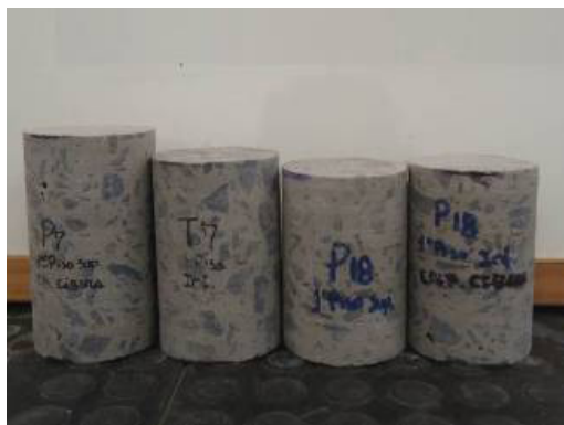
Figuras 4 y 5 – Extracción de probetas testigo de losa postensionada.
