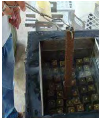
Figura 4- Instante de retirada da barra do banho térmico.
