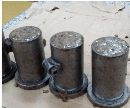
Figura 3 – Moldagem das amostras.
