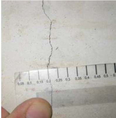
Figuras 1 y 2 – Medición del ancho de una fisura y medición de la profundidad de una fisura con equipo de ultrasonido.
