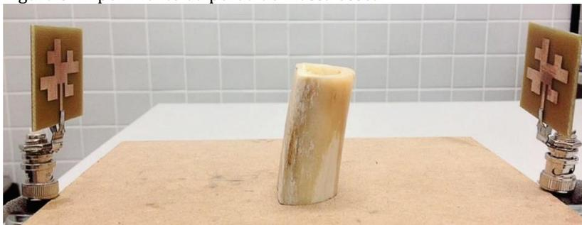
Como o diagrama de radiação das antenas de microfita é diretivo, as antenas foram posicionadas em paralelo e entre elas foram inseridas as amostras de teste. A onda eletromagnética emitida pela antena emissora, localizada à esquerda, será recepcionada pela antena receptora que está localizada à direita. O osso servirá como um obstáculo entre a emissão e a recepção do sinal. Dessa forma foi possível quantificar a atenuação do sinal emitido.
