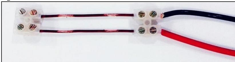
Os conectores de fios foram envolvidos por fita isolante, a fim de impedir que água, ou terra úmida se acumule em suas cavidades, provocando assim alterações nos valores coletados. Como o fio de cobre já possui esmalte próprio, não foi necessário usar nenhum outro tipo de proteção contra a ferrugem, pois, o próprio revestimento do fio já realiza esta função. Como teste, os sensores ficaram mantidos em solo úmido por um período de 20 dias, e estes não apresentaram sinais de oxidação.
