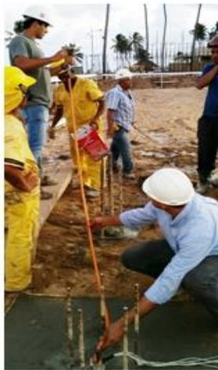
Para a instrumentação em profundidade do ensaio PC3 foram utilizados extensômetros elétricos de resistência, instalados em frações de 0,60m de barras de aço CA-50 com diâmetro 12,5mm. Utilizaram-se extensômetros especiais para aço, colados em ponte completa e protegidos com uma resina especial a fim de se evitar danos devido à umidade e choques mecânicos.
