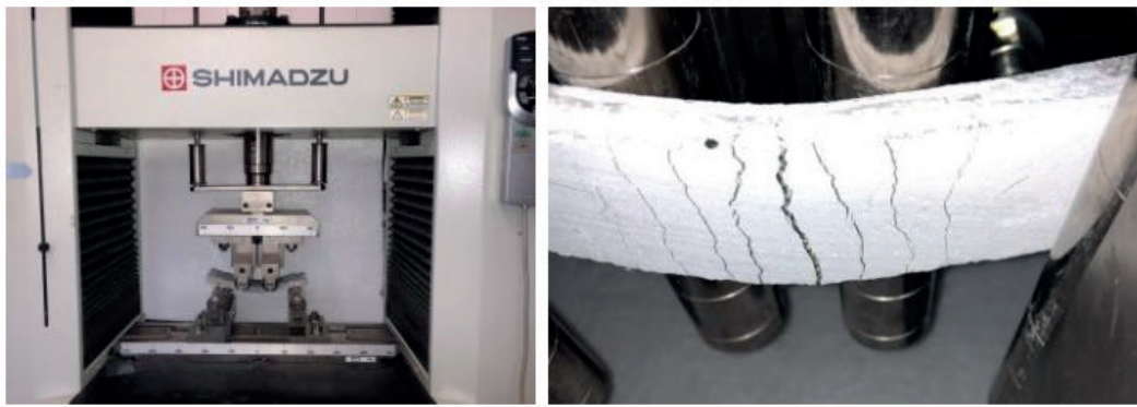
Figura 2 - Realização do ensaio de flexão em quatro pontos nos compósitos.
