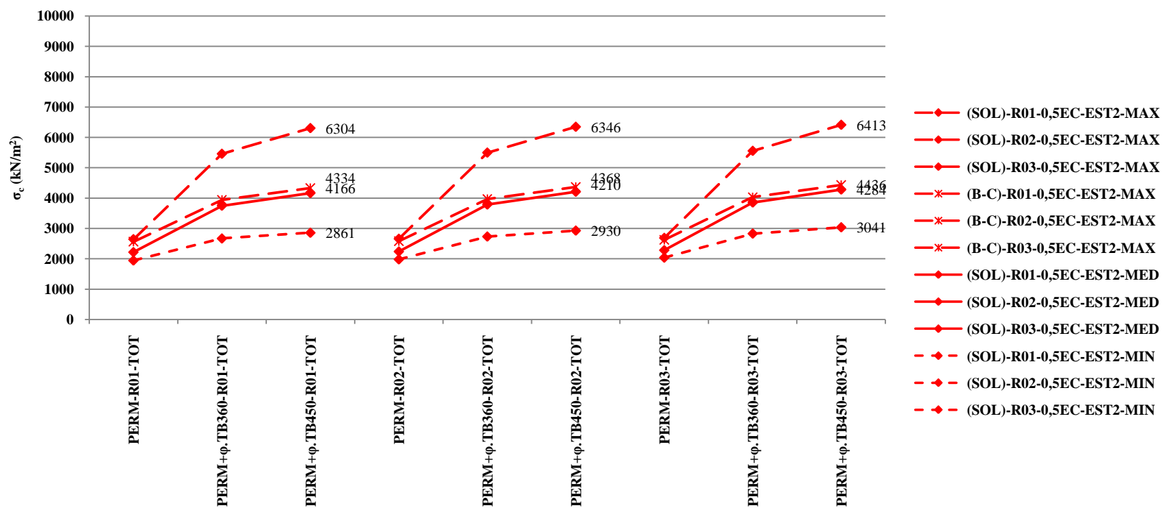
Figura 2.79 – Variação das tensões de compressão mínima, média e máxima no topo do tabuleiro com \rho , para os modelos (B-C) e (SOL), no Estádio 2, módulo de deformação 0,5.E_c , com impacto, provocadas por {PERM}, {PERM + \phi .TB360} e {PERM + \phi .TB450}
