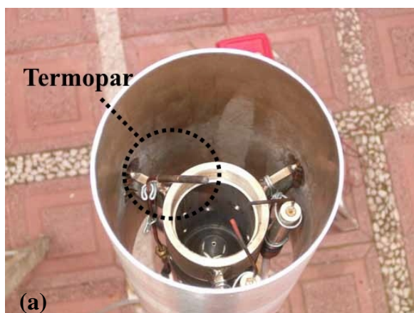
Figura 5 - Dispositivos integrantes de um queimador: (a) termopar para medição da temperatura da chama e (b) centelhador de chama piloto alimentado com painel solar.
