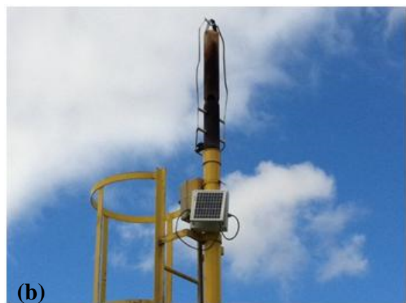
Figura 5 - Dispositivos integrantes de um queimador: (a) termopar para medição da temperatura da chama e (b) centelhador de chama piloto alimentado com painel solar.
